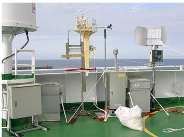
図 3 みらい MR06-4 次航海での最上甲板に設置した風向風速制御装置、霧水採取器、ハイボリュームエアサンブラ、粒径別霧粒採取器
