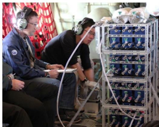
図 3 C130H 機上でのサンプリングの様子
