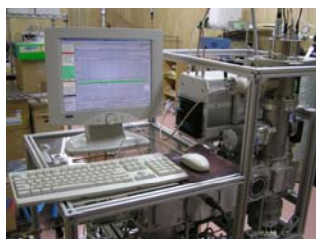
図 2. 常時観測用エアロゾル質量分析計
