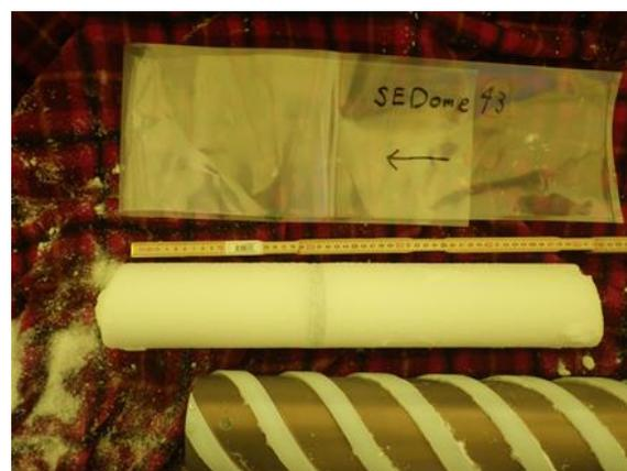
図1 掘削した後のアイスコア グリーンランド南東部で2015年5月に撮影。アイスコアの中央付近に見える黒層は2006年夏の融解再凍結層。アイスコアの下に映っているらせん状の筒は掘削機の一部。
