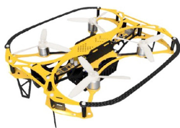
図1 屋内調査用の小型ドローン(外形寸法 191x179x54 mm, 重量 185 g)の写真(左)と天井裏飛行の様子(右)。(Liberaware 社プレスリリースより)
