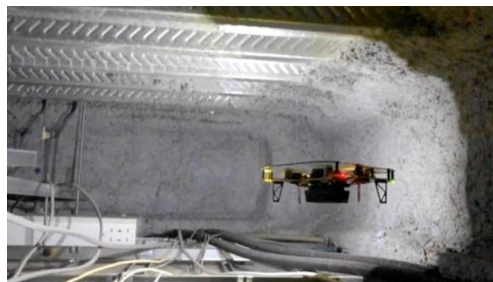
図1 屋内調査用の小型ドローン(外形寸法 191x179x54 mm, 重量 185 g)の写真(左)と天井裏飛行の様子(右)。(Liberaware 社プレスリリースより)
