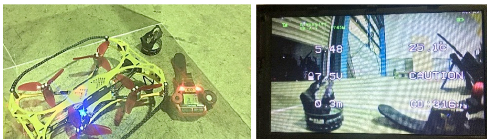
図 2 CO 検知実験のデモンストレーションの様子(左)と濃度表示を操縦者画面に重ねたディスプレイの例(右)。(Liberaware 社プレスリリースより)
